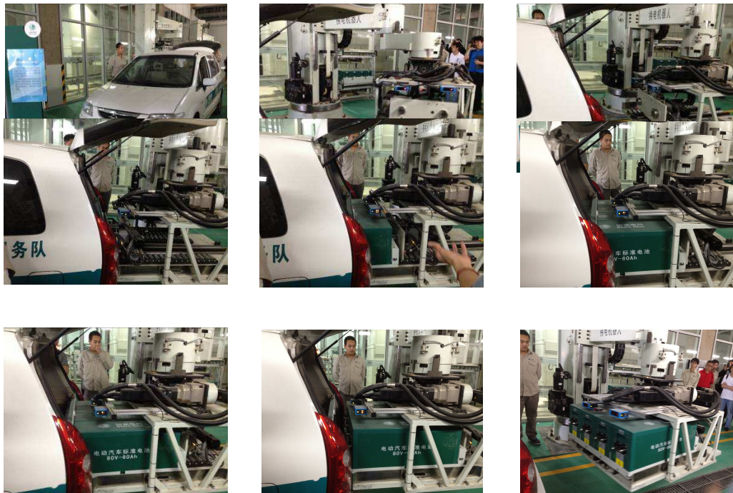
(EV 車から電池を取り出す)
